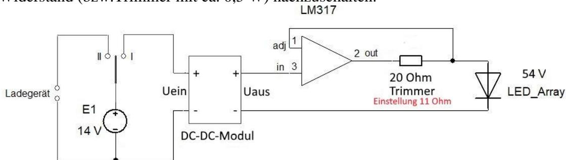
Das DC-DC-Modul wird mit seinem Trimmer auf etwas mehr als die notwendige Ausgangsspannung eingestellt und durch den Trimmer am LM317 wird der benötigte Strom einjustiert ( $I_{\text{begr}} = 1,2\text{V}/R_{\text{Tr}}$ ). Die Spannung kann dann soweit zurückgenommen werden, dass über die Strombegrenzung der minimal mögliche Spannungsverlust entsteht (ca. 3V). So wurde praktisch ein Wirkungsgrad von 83% erreicht.
