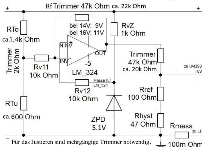
In der Schaltung kann die Störgrößenaufschaltung durch einen OV erfolgen. Dazu wird die Schaltung am Eingang erweitert. Bei  $U_{Bat} = 16 \text{ V}$  wird mit dem Trimmer (2 k $\Omega$ ) OUT auf Null justiert. Sinkt die Batteriespannung, wird INV von LM324 kleiner ( $U_{ZPD}$  bleibt dagegen gleich). OUT wird dann durch Invertieren größer. Die Verstärkung ist entsprechend zu justieren.
