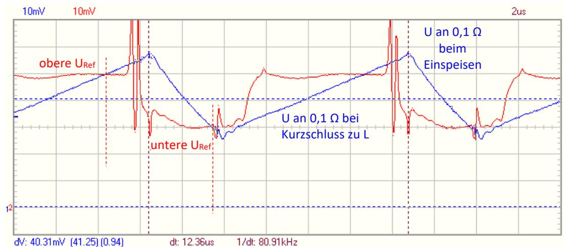
Die Zeitverzögerung beim Schalten entspricht den Angaben im Datenblatt des LM393 (Ausgang offen ca. 1,5  $\mu$ s, durchgeschaltet ca. 0,5  $\mu$ s). Die Hysterese ist deutlich. Die Schwingungen ergeben sich bei nicht voll durchgeschalteten MOS Transistoren.
